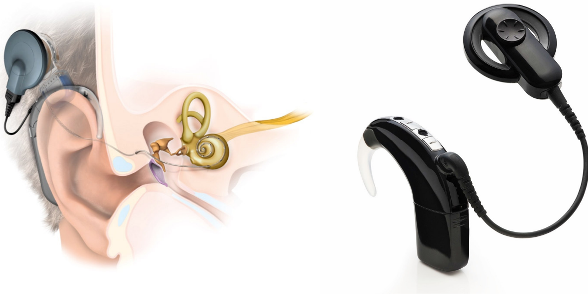
Abb. 7: Cochlea Implantat und Soundprozessor
